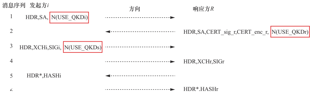
图5 IPsec融量子第一阶段交互示意图
